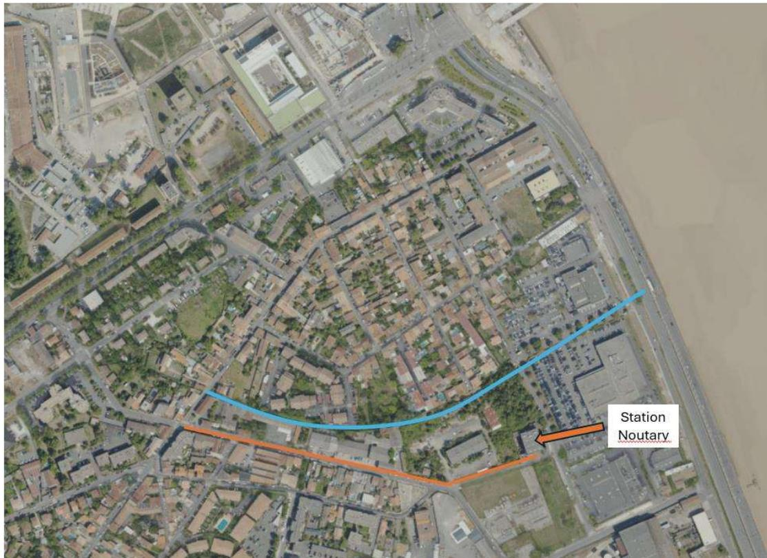
maisons voisines. L'eau claire de l'Estey s'écoule dans le réseau d'assainissement (en orange), sans pouvoir être isolée aujourd'hui, jusqu'à la station Noutary, qui est une station dite « de relevage » qui permet d'acheminer les eaux usées jusqu'à la grande station d'épuration de Clos de Hilde (Bègles, Rives d'Arcins), qui a une capacité de traitement de 410 000 équivalents-habitants.
